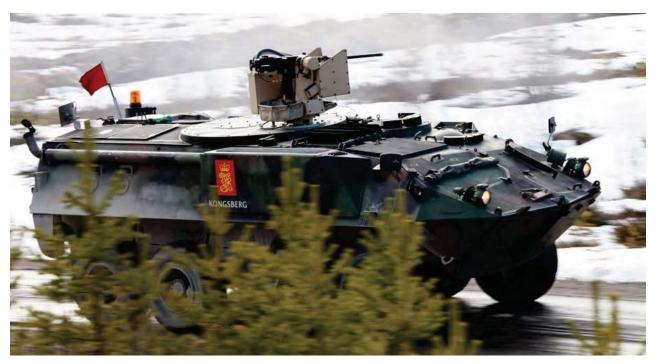
مدفع الرشاش الخاص بالقنابل MK19 Grenade Machine Gun والمدفع الرشاش MB)) والمدفع الرشاش M240 والمدفع الرشاش M240 عن بُعد انطلاقا من منصة ثابتة أو من وضع الحركة.
